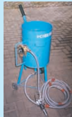
Иньекторный котёл для лёгких струйных работ, включая 4 м пакет шлангов и иньекторный пистолет
